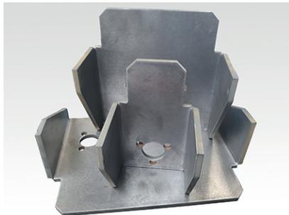
Motorkonsole, Wst. 1.4301 Wasserstrahl
